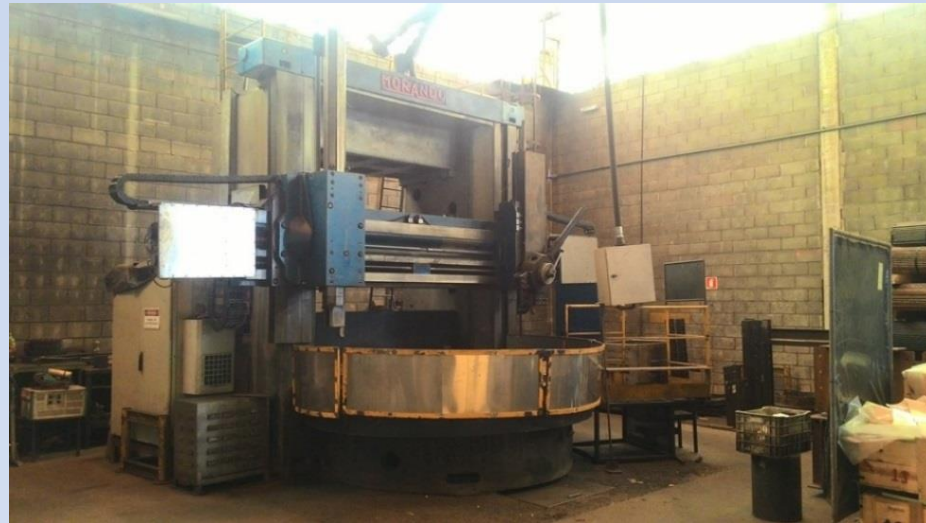
TORNO VERTICAL CNC - MORANDO KM25 – PLACA Ø 2.500 X 1.800
