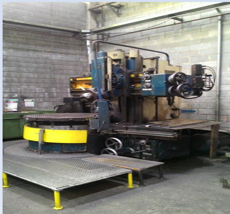
TORNO VERTICAL – KNA 110 – PLACA Ø 1.000 X 1.020
